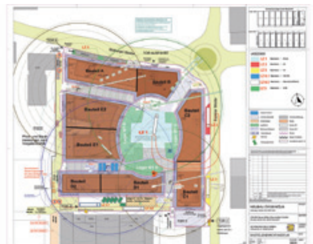
Beispielplan, aus dem man die verschiedenen Zufahrten, Krane, Zonen und Lagerflächen erkennen kann (Quelle: LEAN Projektmanagement GmbH)
